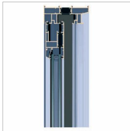
Sistema de puerta perimetral que iguala estéticamente la perfilaría de los sistemas abisagrados Cor-70 C.C., Cor-70 Hoja Oculta C.C., Cor-65 C.C., Cor-55 C.C. y Cor-50 C.C.
